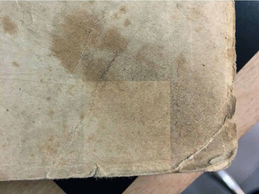
Ил. 11. Фрагмент страницы из первого тома полного собрания сочинений М. Е. Салтыкова-Щедрина после лазерной очистки
