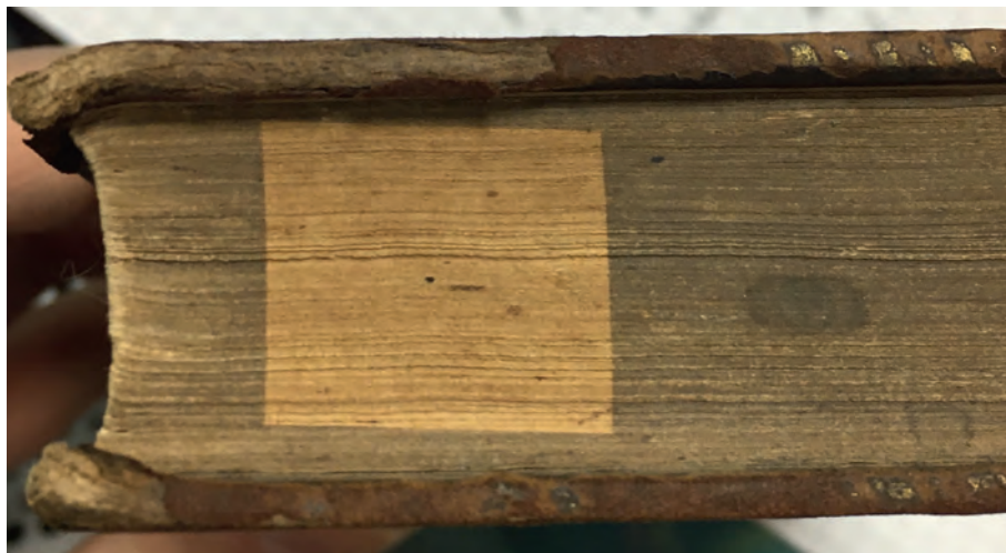
Ил. 12. Обрез книги XVIII в. после лазерной очистки
