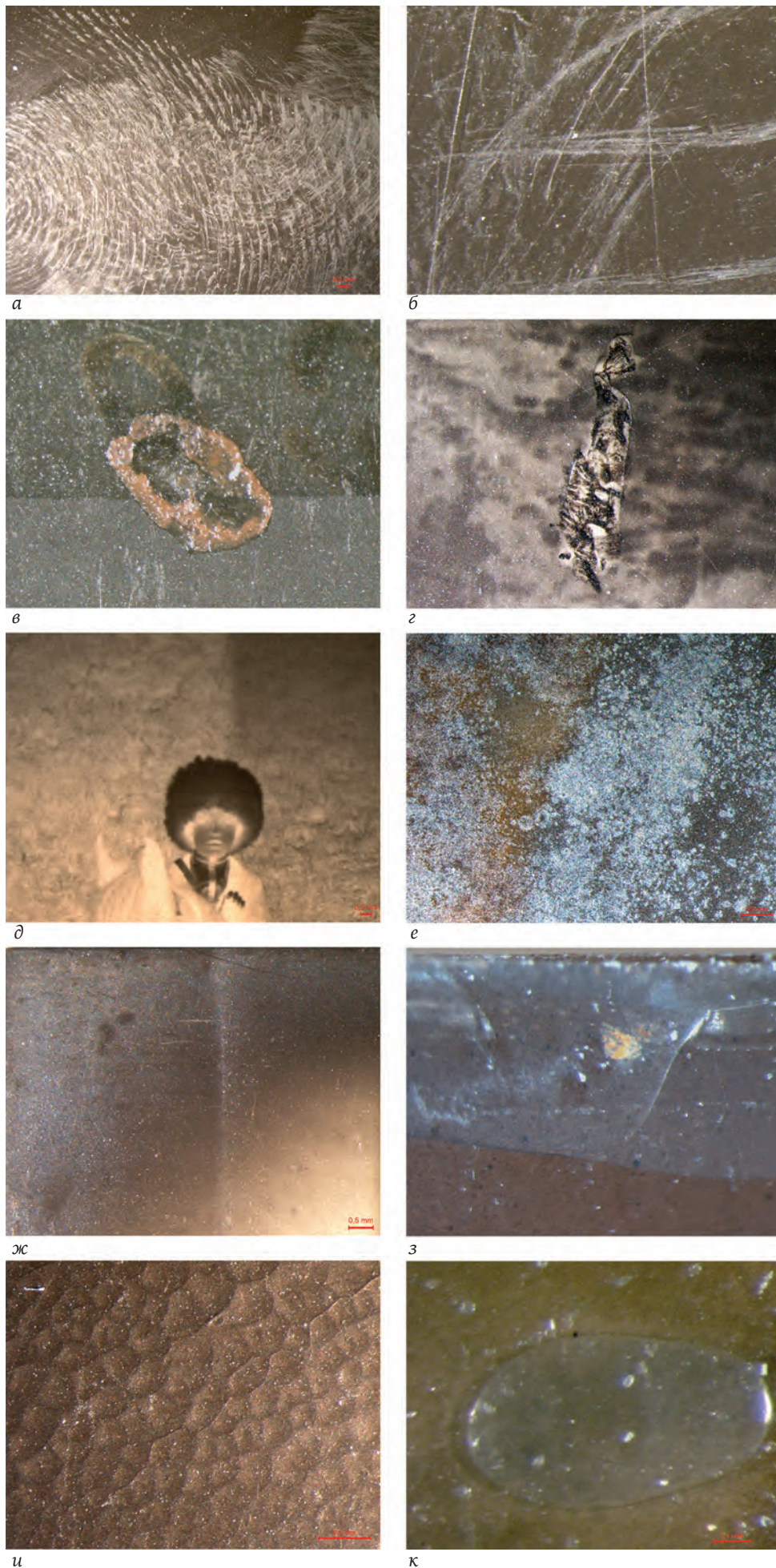
Ил. 7. Микрофотографии дефектов негативов: отпечатки пальцев (а), царапины (б), пятна и дефекты эмульсионного слоя (в), нарушение сохранности эмульсионного слоя (г), изменение тональности, угасание (д), изменение цветовой гаммы (е), наличие металлизации со стороны эмульсионного слоя (ж), отслоение эмульсионного слоя (з), растрескивание эмульсионного слоя (и), образование пузырей (к)
