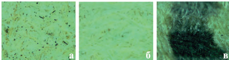
Ил. 7. Снимки, полученные при помощи оптического микроскопа, фрагментов очищенной лазером газеты: а — до чистки; б — после чистки; в — удаленный лазером верхний слой печатных чернил
